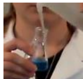
(d) Tia nước cất xung quang bình nón để đảm bảo tất cả thể tích chính xác dung dịch đã lấy được phản ứng với chất chuẩn
