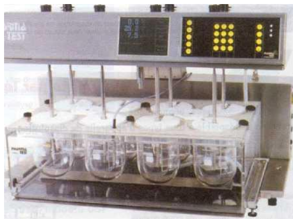
Hình 9.4. Máy thử độ hòa tan
