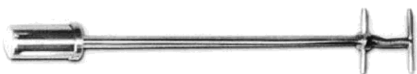
Hình 2. Tuýp lấy mẫu chế phẩm lỏng và chế phẩm bôi ngoài da
