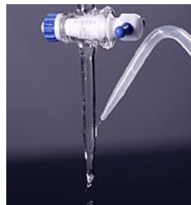
(c) rửa đầu buret bằng nước cất
