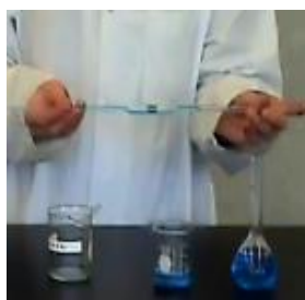
(a) tráng pipet bằng chính dung dịch cần lấy
