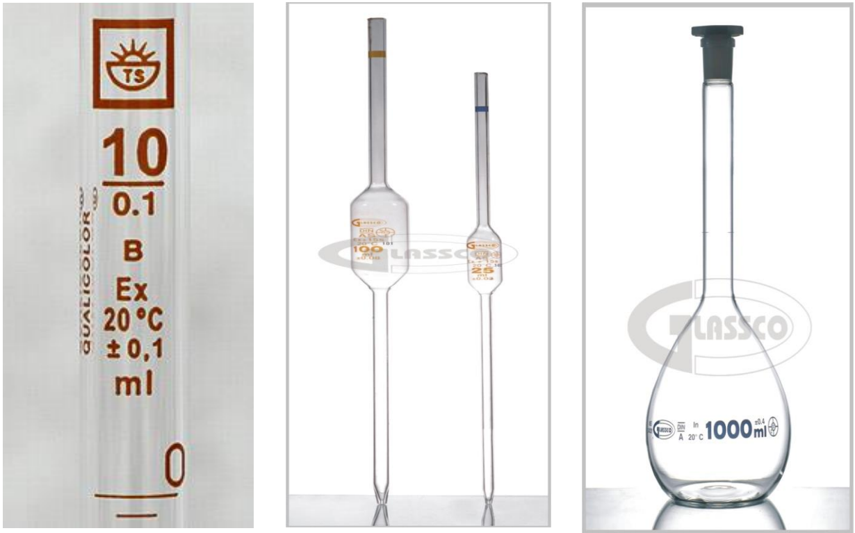
Hình 1. Một số loại pipet và bình định mức có ghi kèm dung sai
