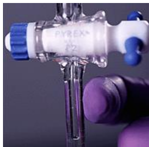
(b) Kiểm tra xem có còn bọt khí ở khóa van không
